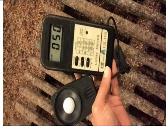
**Gambar 3.** Light meter (pengukur cahaya)
